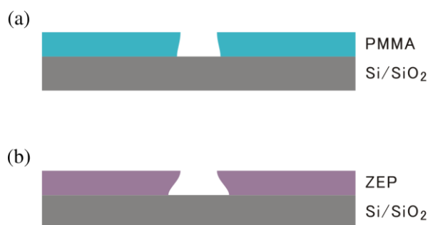
図 3.2 : (a) PMMA レジスト、(b) ZEP レジスト。
