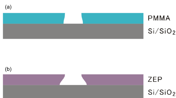
図 3.2. 現像後のレジストと基板の断面の模式図。(a)PMMA レジスト。(b)ZEP 単層レジスト。 図のようなアンダーカット構造を実現することで、清純な金属端面を得ることができる。
