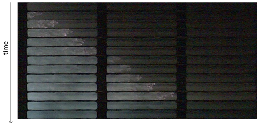
図 4.7 推進機内部のプラズマ伝搬
