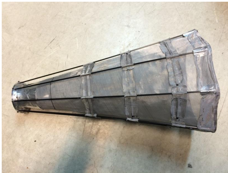
図 3.21 メッシュ壁を利用した正8角形テーパ管型集光器
