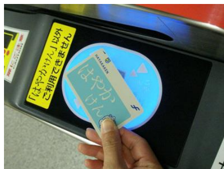
図 2.1 電磁誘導によるワイヤレス電力伝送を用いた IC 乗車券 (福岡市交通局)
