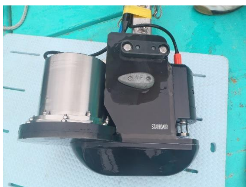
Fig. 4 GeoSwath Plus Compact (図中下部の黒い送受波器)、POS/MV 慣性ジャイロ (銀色の円筒)、miniSVS (送受波器右上)
