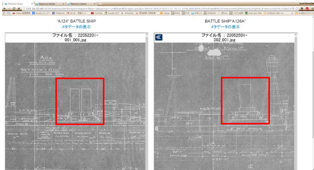
図 5-8 比較機能を用いた煙突本数の比較結果
