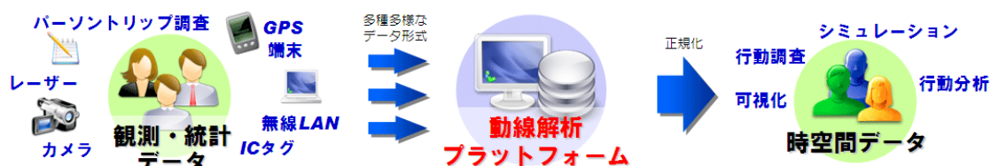
図 2-8 動線解析プラットフォームの役割 (東京大学「人の流れプロジェクト」より引用)
