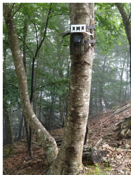
Fig. 2. 2. 2 東京大学秩父演習林に設置している赤外線カメラと気温センサー
