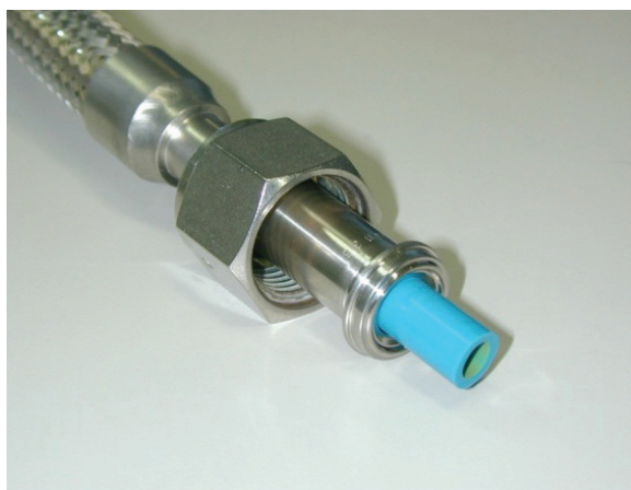
Figure 3.4 BL20B2 の分光器内部の配管変更の様子。水流による振動を抑制するために、フレキシブルチューブにウレタンチューブを挿入した。
