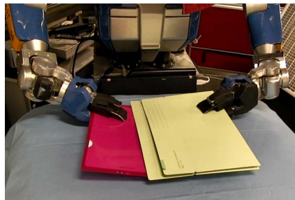
図 4.14: フォルダへのファイル挿入動作試行後のフォルダとファイルの三状態 . State “s” (相互重畳) はファイルがフォルダに入っている状態である . また , state “u” (片側遮蔽 , 上) および state “d” (片側遮蔽 , 下) はフォルダにファイルが入らず , それぞれ上または下にずれ , 挿入に失敗している状態を表す . 下段の図は , ロボットの視野画像に , ファイルとフォルダの追跡結果を赤線でオーバーレイしたものである ( 著者論文 [106] より )
