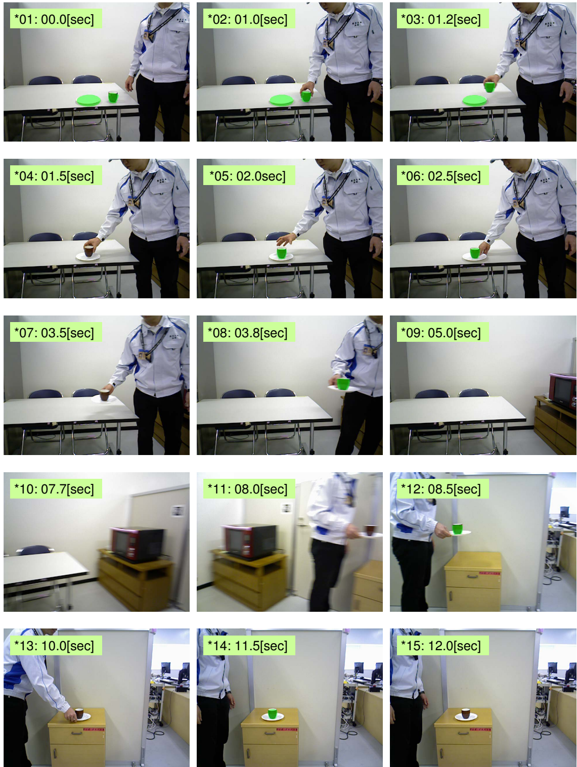
図 5.34: 改良 LINE-MOD による観察対象の追跡結果 (観察 HSR-OBS2) . 対象が認識された時刻には, 緑色で対象のテンプレートを重畳表示している (著者論文 [104] にて一部抜粋した図を发表済)
