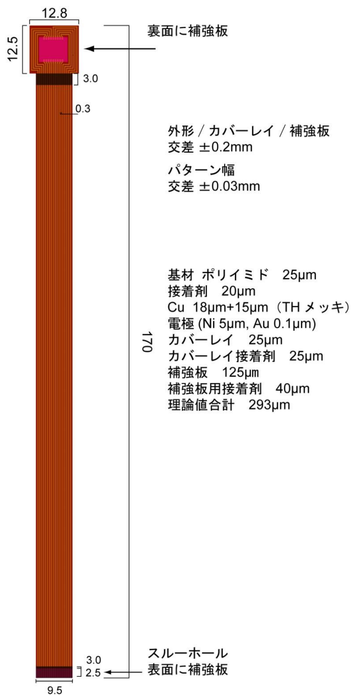
Fig. C.5 18 端子のフレキシブル配線の設計
