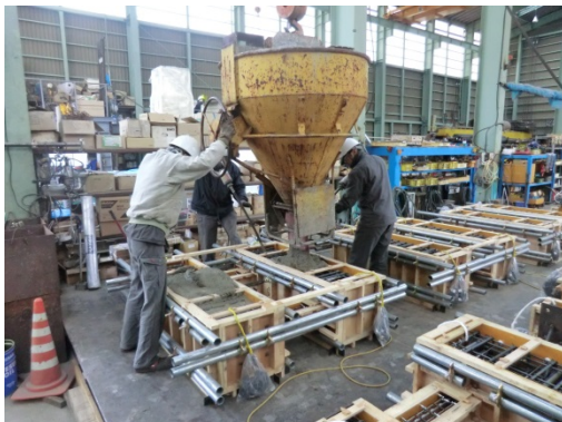
(c) コンクリート打設の様子
