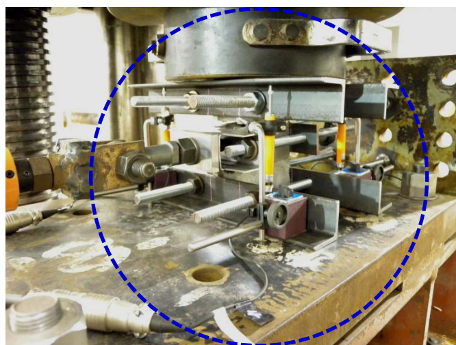
写真 2.10 押し抜き試験の加力装置と試験様子（1列3段試験体）
