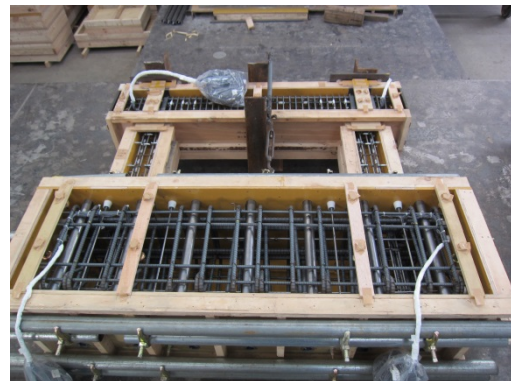
(b) 柔梁型試験体の型枠 (IFFB)
