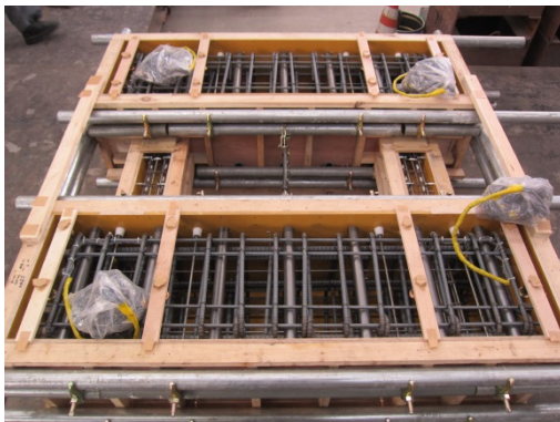
(a) 剛梁型試験体の配筋 (IFRB)
