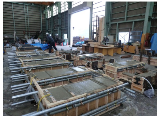
(d) コンクリート打設の直後
