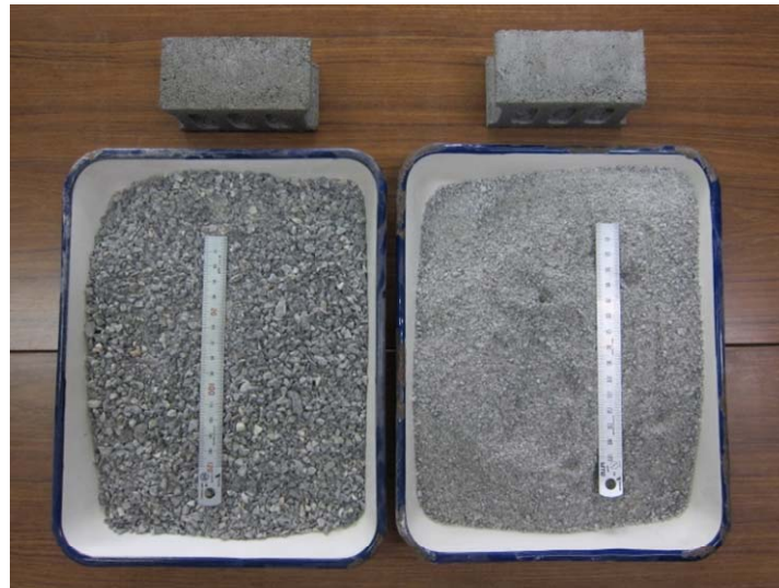
写真 3.1 本研究の縮小ブロックにおける骨材サイズの変更（左図：既骨材，右図：新骨材）
