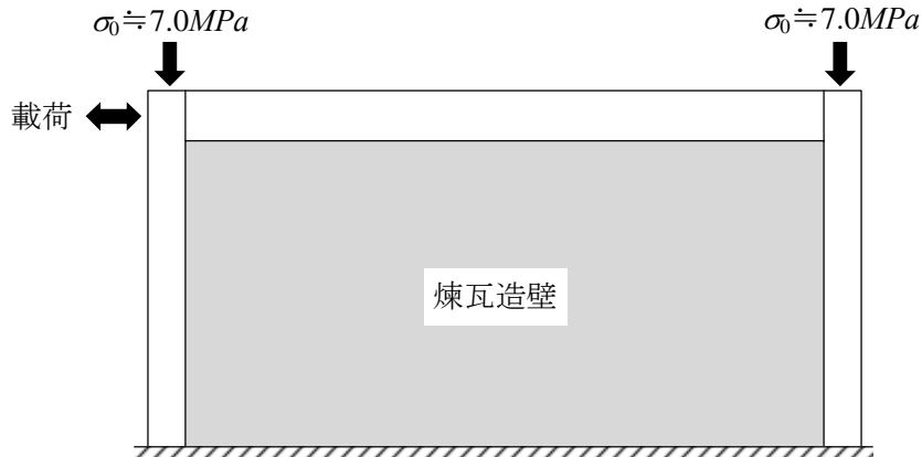
(a) 無補強組積造壁を含む RC 造架構試験体の概略
