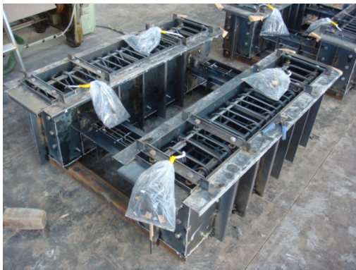
(a) 剛梁型試験体の配筋 (IFSB)
