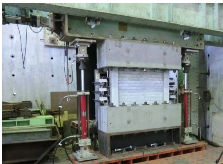
写真 3.8 IFRB 試験体の載荷システムの全景
