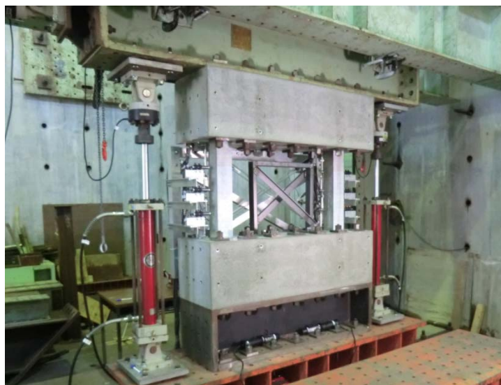
写真 3.7 BFRB 試験体の載荷システムの全景
