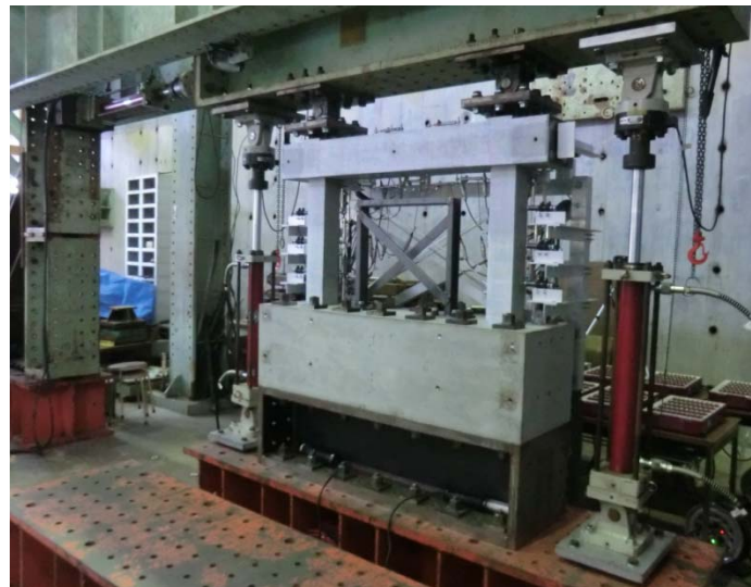
写真 3.9 BFRB 試験体の載荷システムの全景
