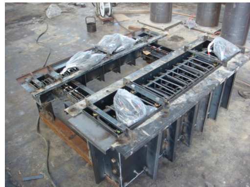
(b) 柔梁型試験体の配筋 (IFFB)
