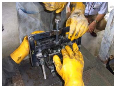
(f) 脱型 (治具脱型)
