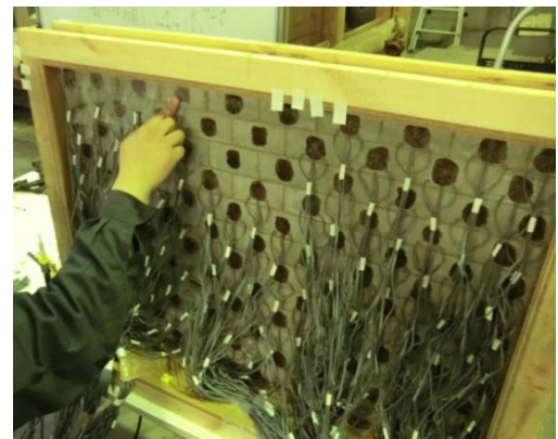
写真 3.5 3 軸ひずみゲージの貼付様子
