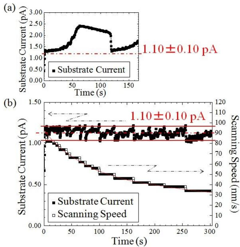
図2 長尺オーバーハングナノワイヤの形成における基板電流と走査速度
