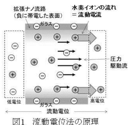
図1 流動電位法の原理
