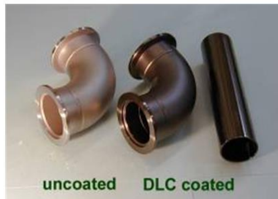
Fig.2.3 バイポーラ PBII&D によるマクロスケール三次元コーティング
