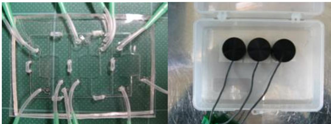
Fig. 2-5 作製したスリーコンパートメントデバイスと磁気モーター
