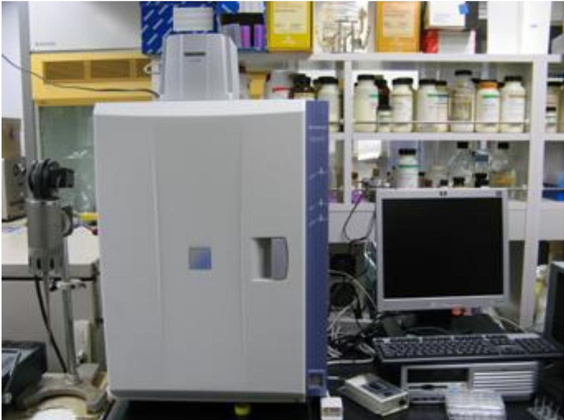
蛍光イメージング装置の概観（蛍光画像取得装置とデータ処理計算機）
