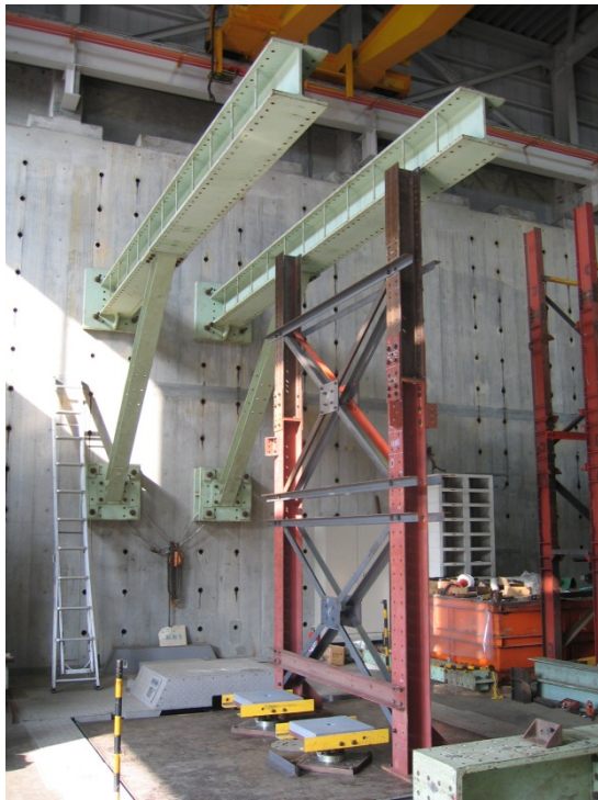
写真 5.2.5 鉄骨治具
