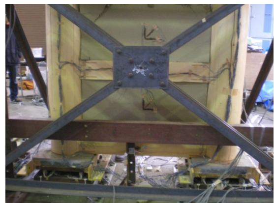
写真 5.3.2 土壁破壊の様子 BCJ-L2100%1 回目終了後（（南（裏）面）
