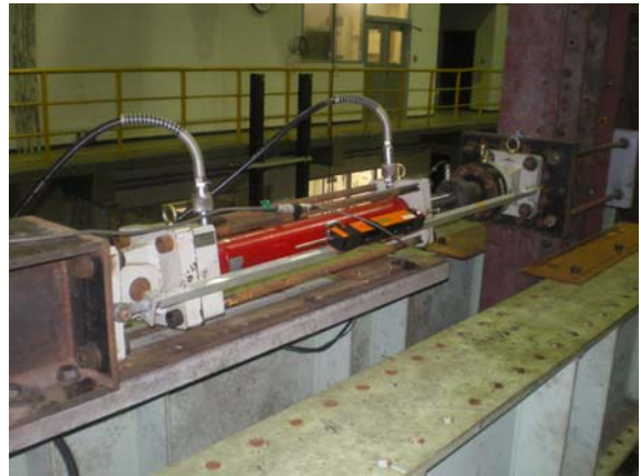
(d) 油圧式ジャッキ (ch. 0)
