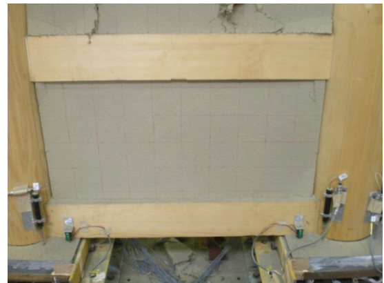
写真 5.3.1 土壁破壊の様子 BCJ-L2100%1 回目終了後（北（表）面）
