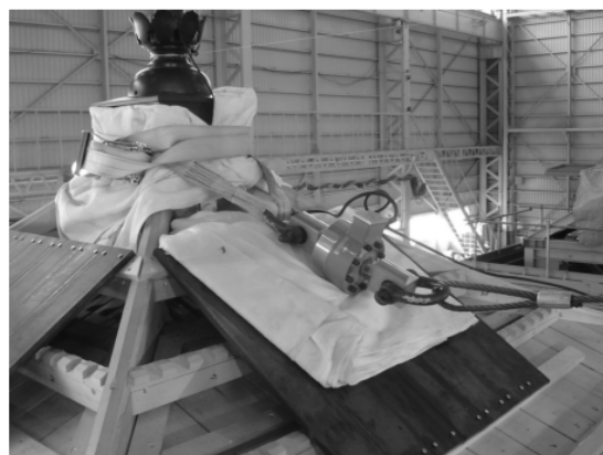
写真 6.2.1 引張試験の様子 6-1)
