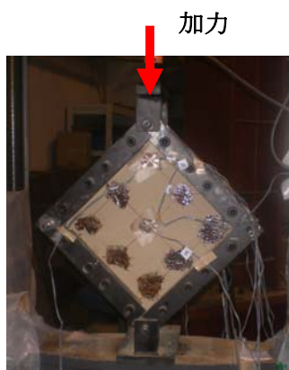
写真 5.4.1 土壁材料実験
