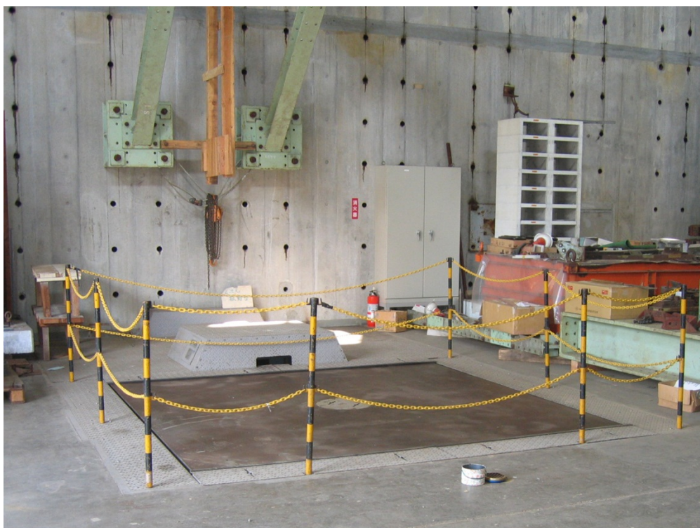
写真 5.2.3 千葉実験所内の 2 次元振動台
