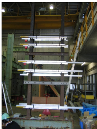
写真 5.2.9 絶対変位計測用の鉄骨タワー
