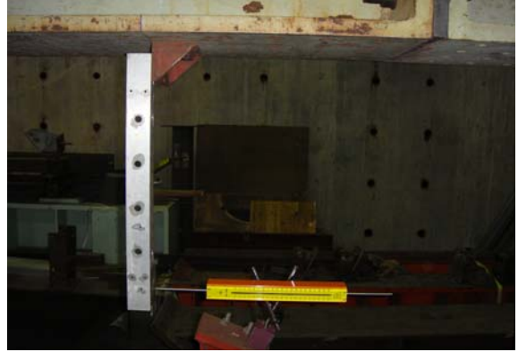
(b) 変位計設置 (ch. 50)
