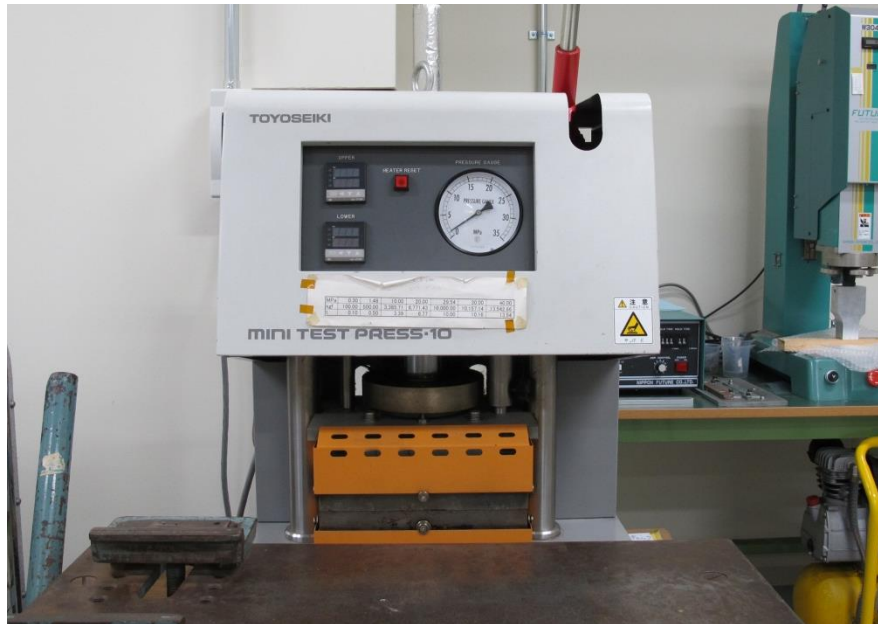
Fig. 4-8. Mini test press machine for CFRP curing
