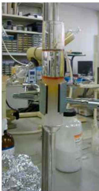
図 2.2.3.2 カラムクロマトグラフィーによるヘキサン抽出物からの夾雑物の分離 (カロテノイドはシリカゲルに保持され、炭化水素画分はシリカゲルを通過する。シリカゲルに保持されたカロテノイドの黄色部分が観察される。)
