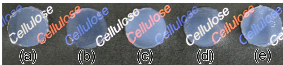
図 2. 各種凝固浴から得られたセルロースヒドロゲルの外観。凝固浴：(a) MeOH、(b) EtOH、(c) Acetone、(d) \text{H}_2\text{SO}_4 、(e) \text{Na}_2\text{SO}_4
