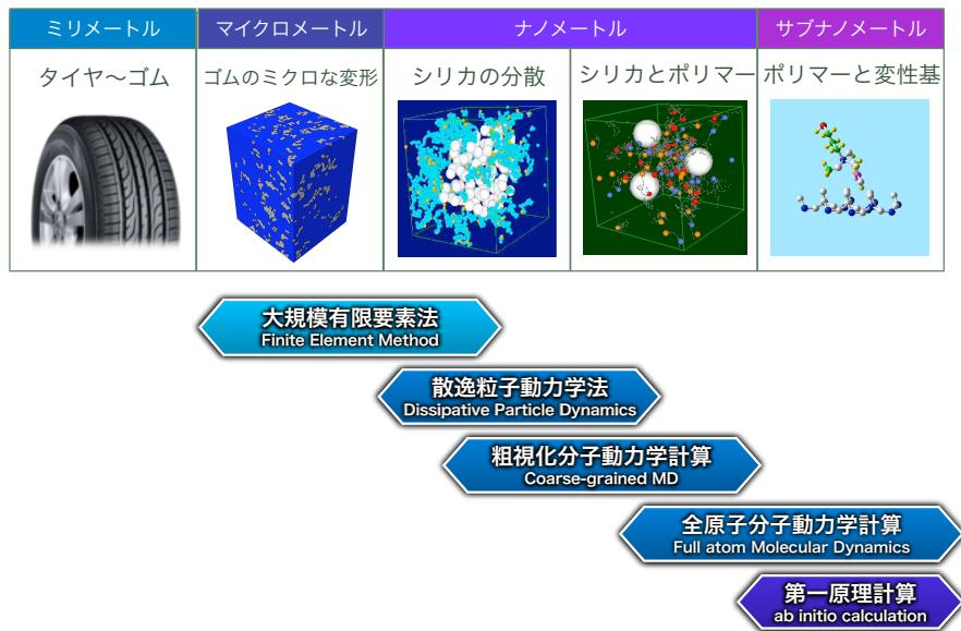
Fig. 3-2-2 各時空間スケールにおける計算シミュレーション法
