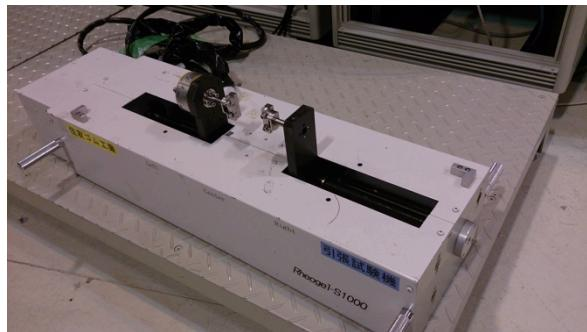
Fig. 3-1-4 ゴム延伸装置の写真
