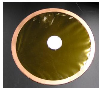
Fig. 3-1-6 Kapton フィルム上にマウントした Al 製減衰板
