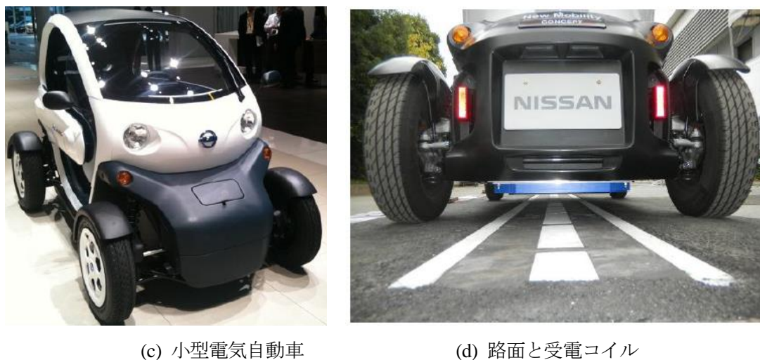
図 4.2 走行中ワイヤレス給電実験 [52]
