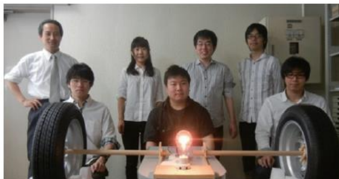
図 1.25 実物のタイヤによる給電実験 [27]
