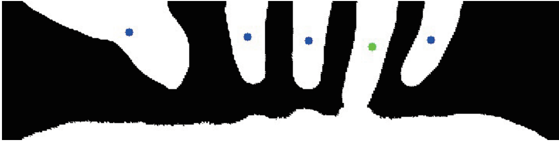
図 4.6. 接触面に右手の薬指が触れている時に得られる画像：タッチしている薬指の重心位置のみ異なる色で表示されている。
