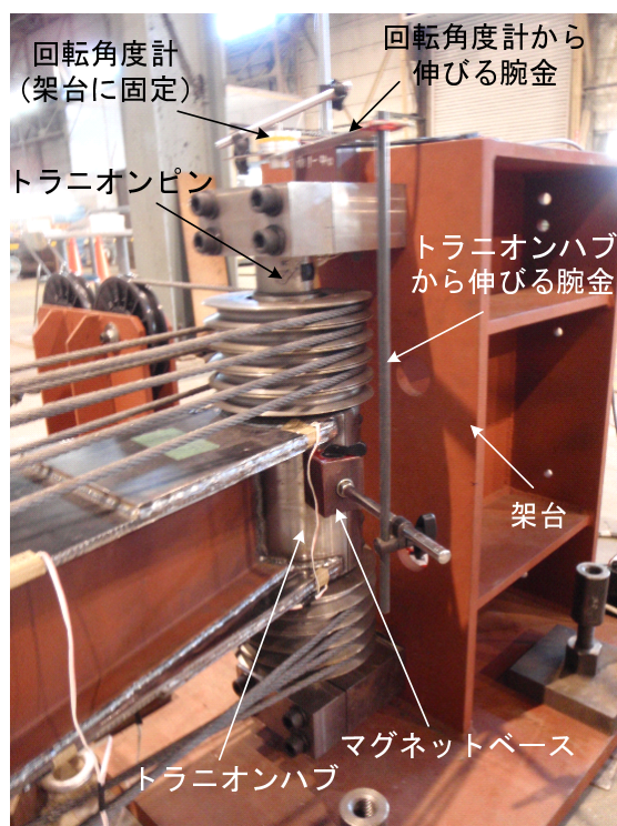
図 2.19 回転角度計の設置状況
