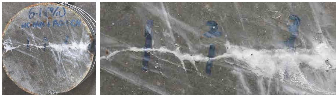
写真 7.4 通水試験後の No.4 (G-A-C+G-B-C) の円柱供試体底面のひび割れ部
