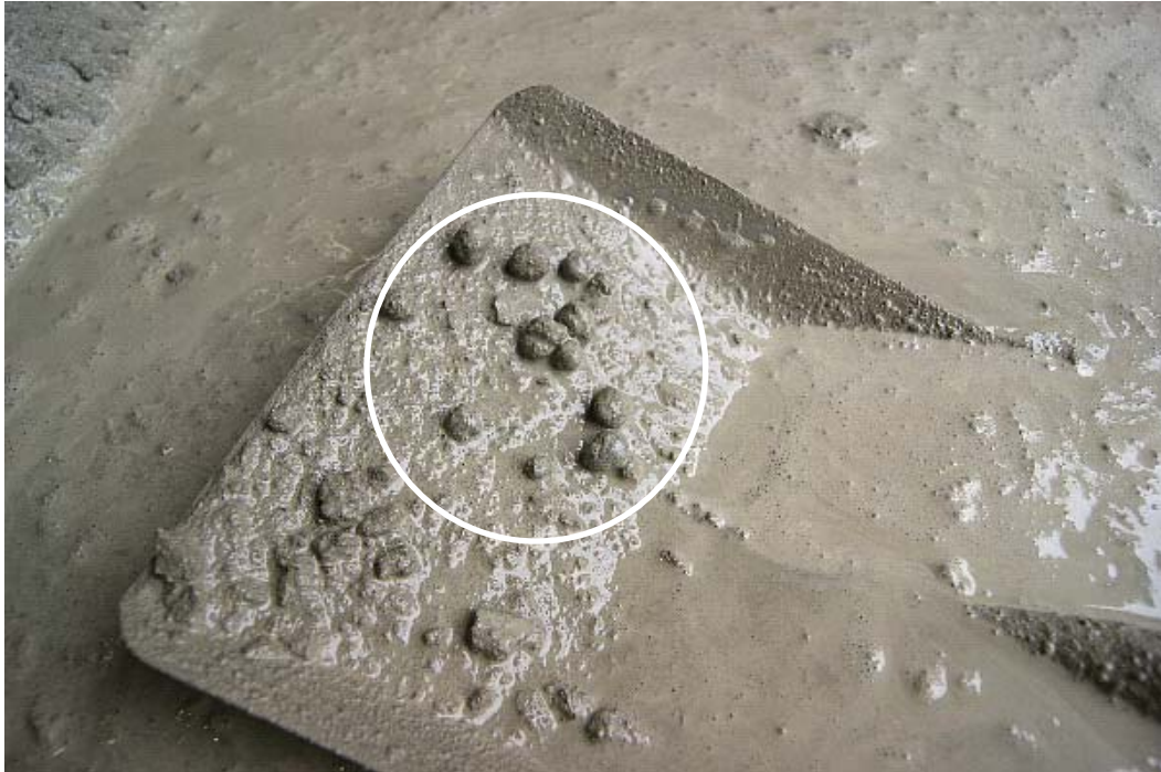
写真 4.17 フレッシュコンクリート中の自己治癒材料造粒物 (Type-2 造粒物)
