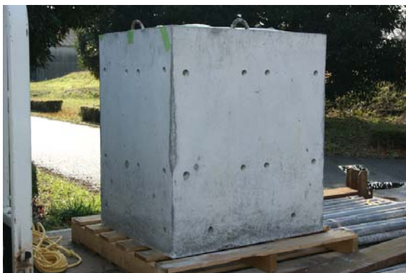
写真 5.5 BFS コンクリートの桁形 RC 試験体
