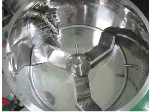
写真 4.1 第1回の造粒に使用した0.025m 3 攪拌造粒機(攪拌造粒)
