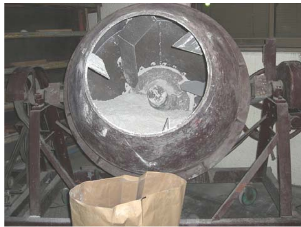
写真 4.2 第2回:0.05m 3 傾胴式ミキサ 写真 4.3 第3回:0.1m 3 傾胴式ミキサ(転動造粒)
