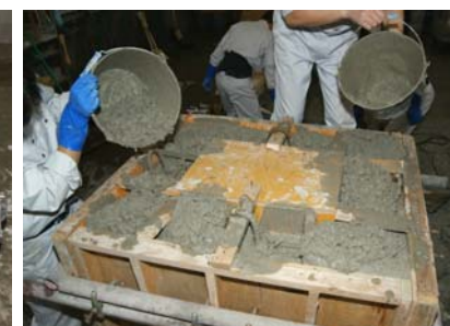
写真5.4 BFSを用いたコンクリートの練混ぜおよび桁形RC試験体（0.54m 3 ）の打設
