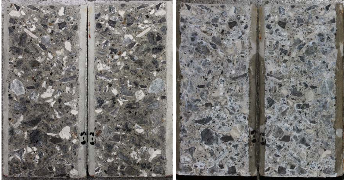
写真 7.5 No. 4 (G-A-C+G-B-C) の円柱供試体割裂断面 (左：通水前, 右：通水後)
