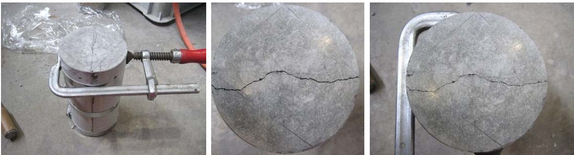
写真 4.11 万力を用いたひび割れ幅の調整（第 2 回実機試験の FRC コンのみ適用）
