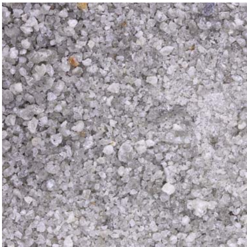
写真 5.1 高炉スラグ細骨材 (BFS2.5) 原寸大
