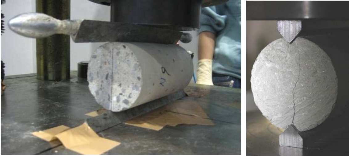
写真 4.10 耐圧試験機および鋼製アングルを用いた割裂（ひび割れ導入） （左；切欠部なし＝第 1～2 回実機試験， 右；△切欠部あり＝第 3 回実機試験）
