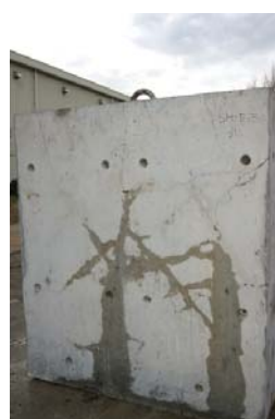
ひび割れ導入後、通水開始 (漏水激しい)
