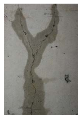
ひび割れ導入後、通水開始 (漏水激しい)
