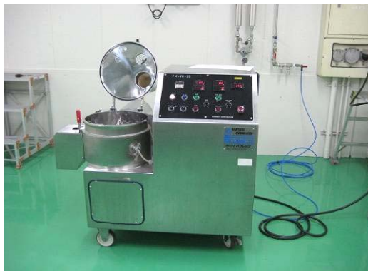
写真 4.1 第1回の造粒に使用した0.025m 3 攪拌造粒機(攪拌造粒)
