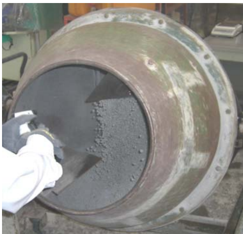
写真 4.2 第2回:0.05m 3 傾胴式ミキサ 写真 4.3 第3回:0.1m 3 傾胴式ミキサ(転動造粒)
