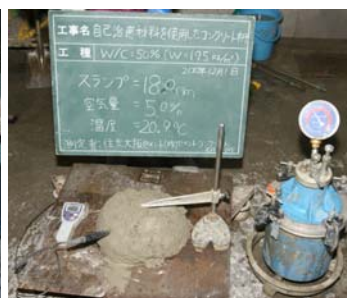
写真5.4 BFSを用いたコンクリートの練混ぜおよび桁形RC試験体（0.54m 3 ）の打設
