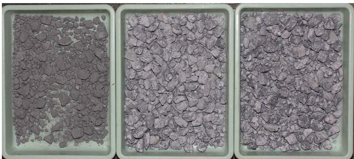
コーティング粗骨材（未使用） 直後に水洗回収 60 分後に水洗回収
