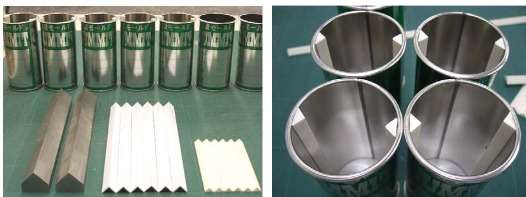
写真 4.9 円柱供試体、割裂用のアングル敷設状況 (写真は φ50×h100mm の場合)
