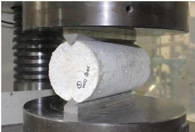
写真 5.7 \phi 100\text{mm} \times h200\text{mm} 円柱供試体の割裂, 通水試験 (常時通水) の様子
