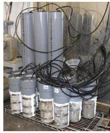
写真 5.7 \phi 100\text{mm} \times h200\text{mm} 円柱供試体の割裂, 通水試験 (常時通水) の様子
