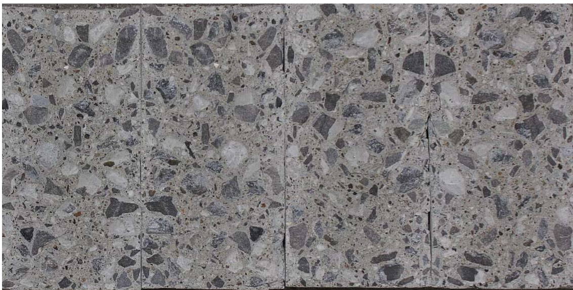
直後に採取した供試体 60分後に採取した供試体 写真 7.14 40℃で 27 日間養生した連続製造プロセスによる自己治癒コンクリートの割裂面
