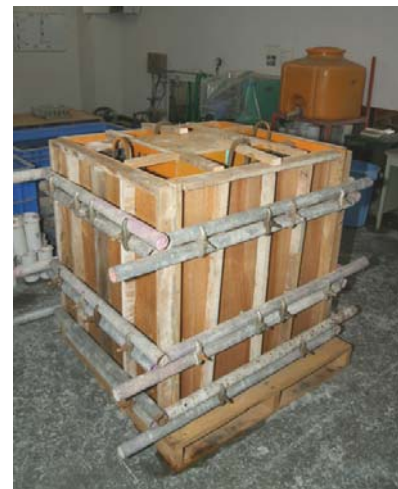
桁形RC試験体の型枠
