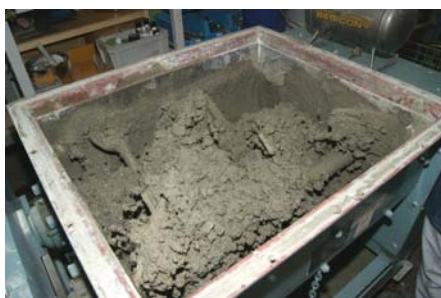
写真5.4 BFSを用いたコンクリートの練混ぜおよび桁形RC試験体（0.54m 3 ）の打設
