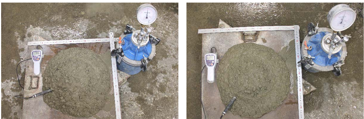
写真 7.10 連続製造プロセスにより製造した自己治癒コンのフレッシュ試験結果 (左：直後に採取したコンクリート，右：60 分後に採取したコンクリート)
