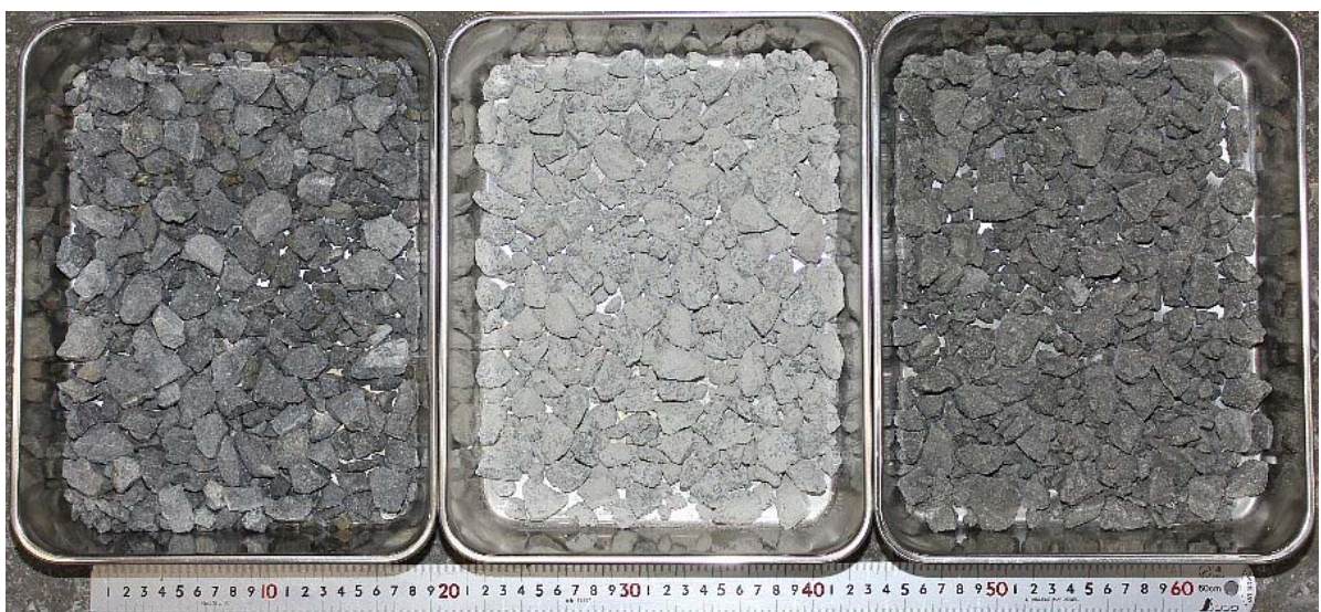
写真 7.2 左から粗骨材 (G), コーティング粗骨材 A (G-A-C), コーティング粗骨材 B (G-B-C)
