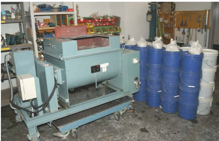
写真5.3 0.1m 3 二軸強制ミキサと材料（0.08m 3 ×9回分）
