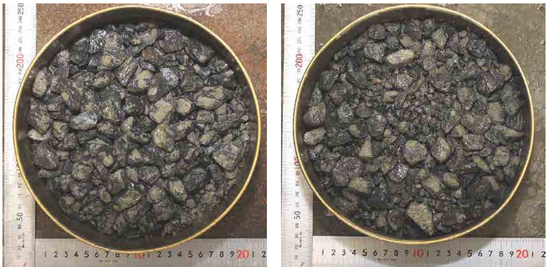
写真 7.11 水洗により分離回収したコーティング粗骨材（左：直後，右：60 分後）
