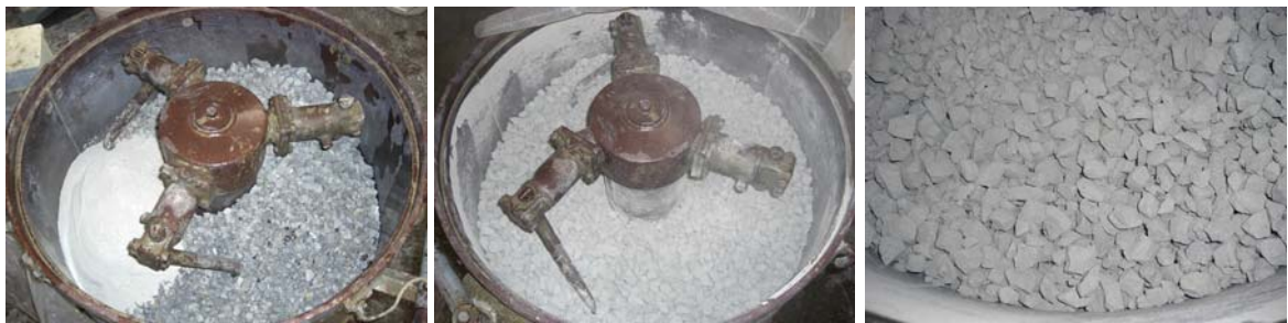
写真 7.1 パン型強制ミキサを用いたコーティング粗骨材 (G-A-C) の作製例
