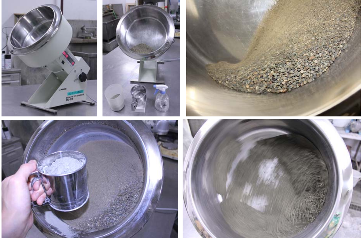
写真 6.1 小型パン型造粒機を用いた転動造粒による細骨材コーティングの様子
