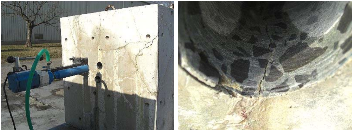
写真 5.8 通水試験開始から1年間経過した BFS コンクリート桁形 RC 試験体からコア採取
