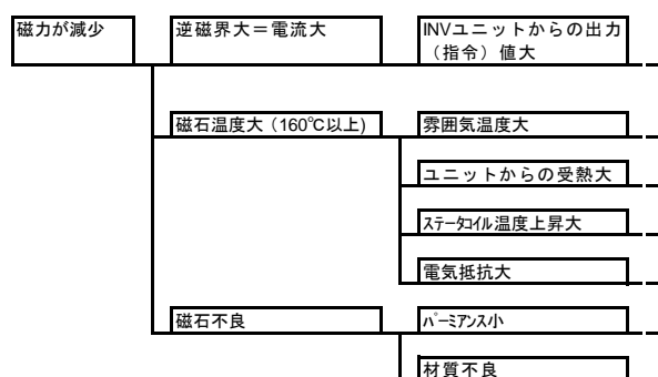
図 4・16 FTA 支援システム (FTAid) 使用による FT 図事例 3
