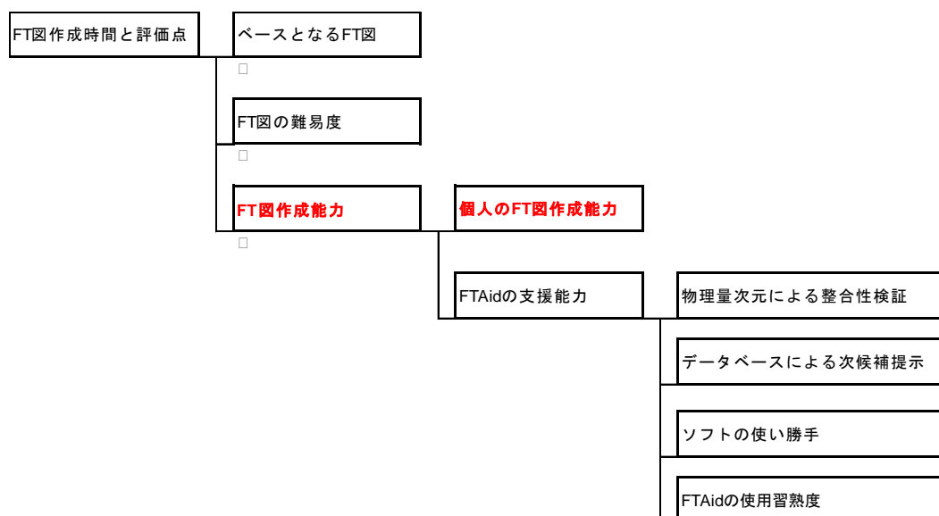
図 4・11 FT 図評価点と作成時間の要因分析
