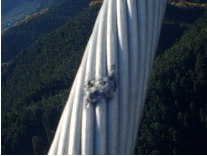
図 2-11 OPGW500 mm 2 の被害状況(1L)
