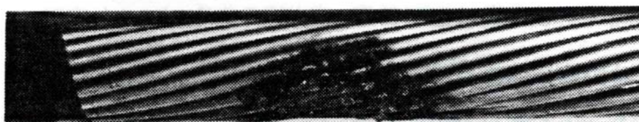
図 2-5 直流アークによる素線溶損の様相例 (通過電荷量 222 クーロン，外層素線が 6 本溶損)
