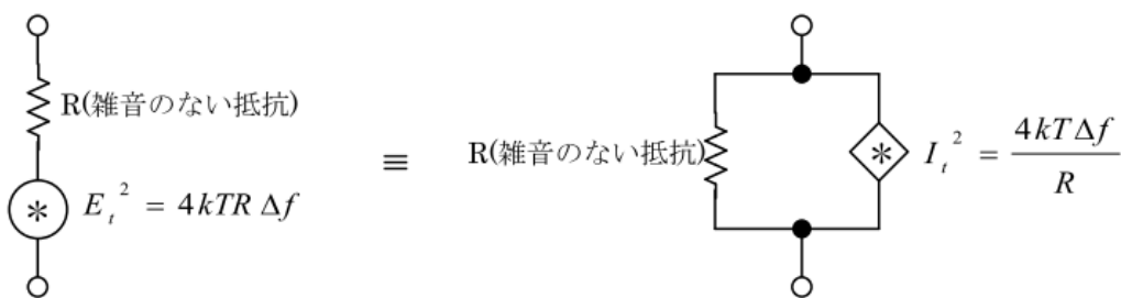
図 2-12 サーマルノイズの等価回路である。雑音電圧源と雑音のない抵抗 R を直列につないだ素子か、ノートンの定理から雑音電流源と雑音のない抵抗 R を並列につないだ素子で表せる。[57]
