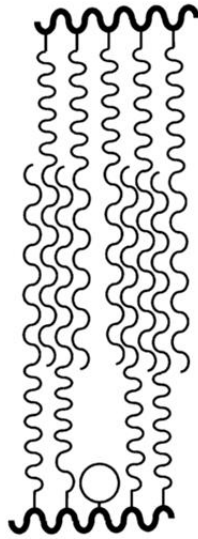
図 4-2 無架橋のステアリル側鎖の構造[95]. 横に伸びている太い線がポリマー主鎖, 上下に伸びているのがステアリル側鎖. 丸いのはジビニルベンゼンを表す.
