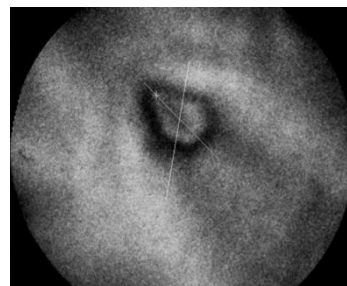
図 2 本研究で用いた収差補正機構付き光電子顕微鏡による Pb/Mo(100)アイランド構造 (視野: 650nm)。空間分解能は約 3nm を達成。
