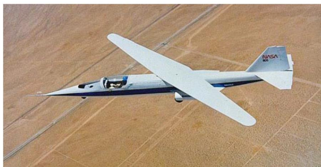
図 1-F 斜め楕円翼の実験機 AD-1（注：亜音速飛行のみでの実証例） [11]
