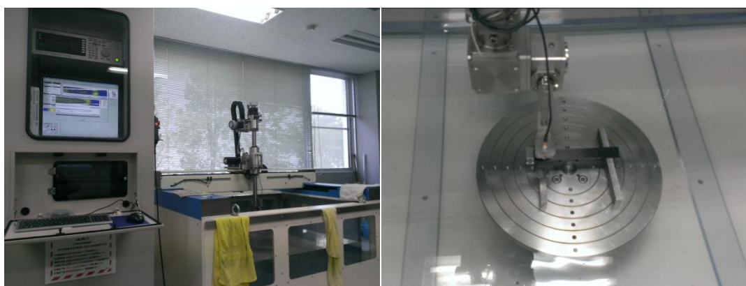
Fig.3-14 水中超音波探傷
