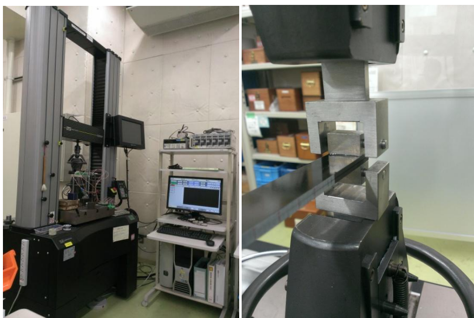
Fig.3-6 万能試験機とDCB試験治具
