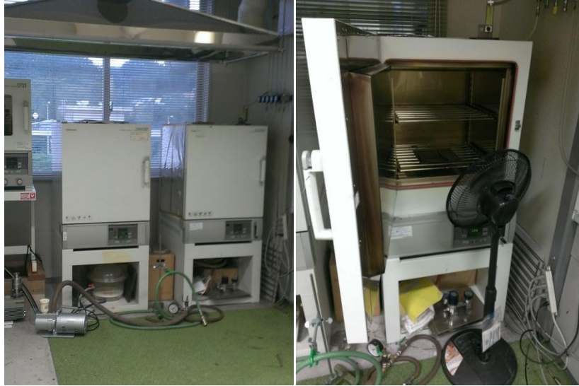
Fig.3-12 イナートオープンと急冷の様子
