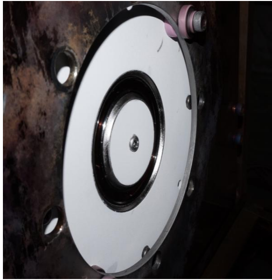
図 2.17 スラスト前面を絶縁体 BN でコーティングした様子
