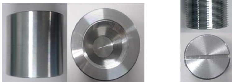
図 2.3. 試料封入用コンテナの設計図と写真（上左：低速度用コンテナ設計図 上右：高速度用コンテナ 設計図 中：ネジ設計図 下左：コンテナ写真（側面） 下中：コンテナ写真（内部） 下右：ネジ写真）。画像黄色部分は金属。コンテナの白部にネジを挿入。試料の密閉の為、ネジはコンテナと触れ合う部分を 30° にしている。
