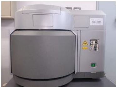
図 2.8. ラマン分光分析器の外観の写真 図 2.9. ラマン分光分析器内部の写真
