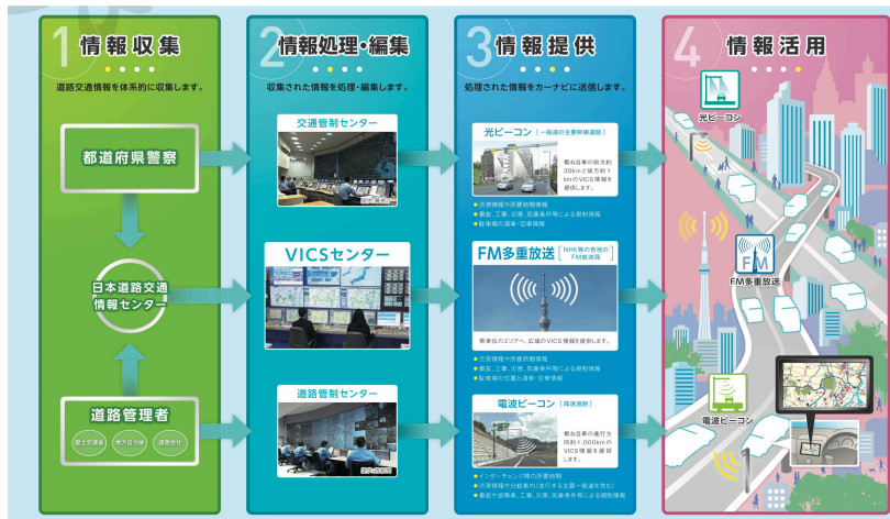
図 11: VICs の概要 (一般財団法人 道路交通情報通信システムセンターより引用)
