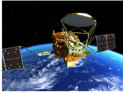
図 2-5 マイクロ波放射計 AMSR2 （出典：JAXA HP[16]）
