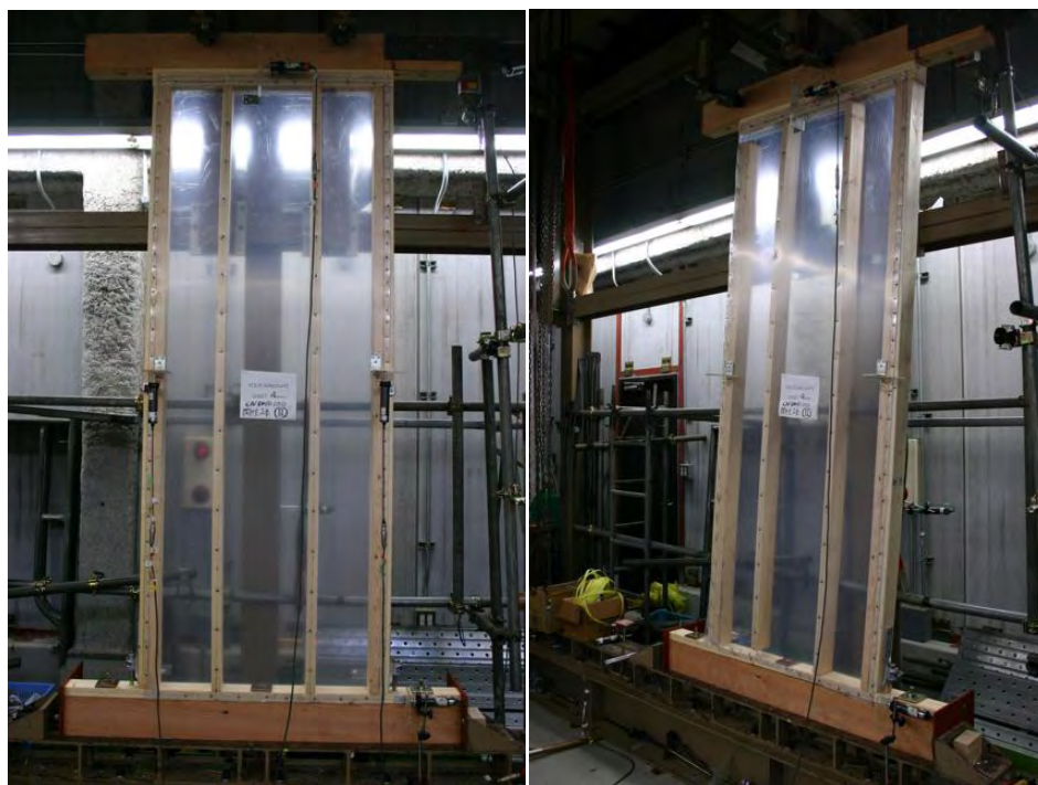
図 25 間柱 2 本+再利用面材
