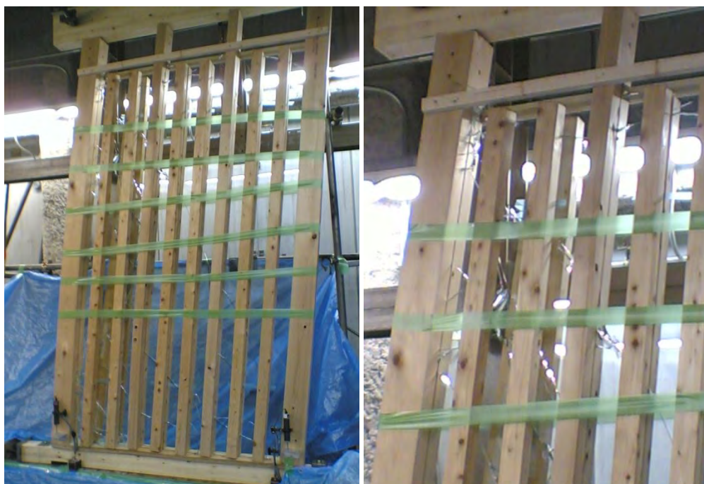
図11 1P ガラス挿入ルーバー耐力壁
