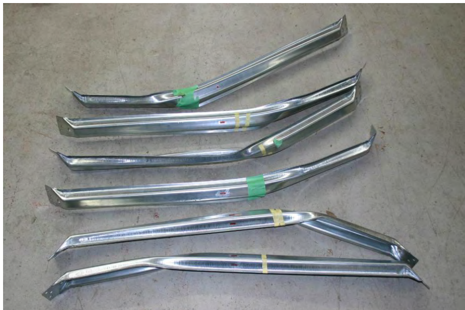
図10 座屈した火打ち金物
