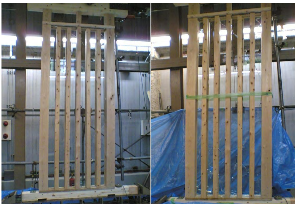
図9 1P ガラス挿入ルーバー耐力壁
