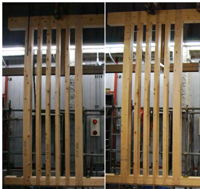
図18 ルーバー試験体の様子 (左：ガラス無、右：ガラス有)
