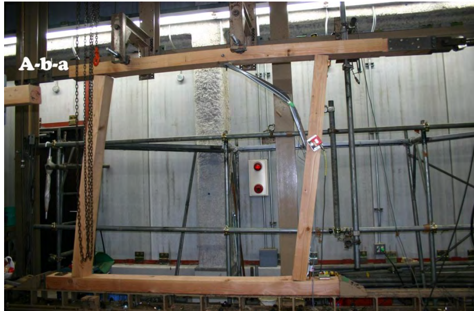
図11 Aタイプ試験体の破壊時の様子
