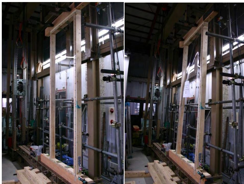
図 12 ポリカ+釘を用いた試験体の加力前と加力中の様子
