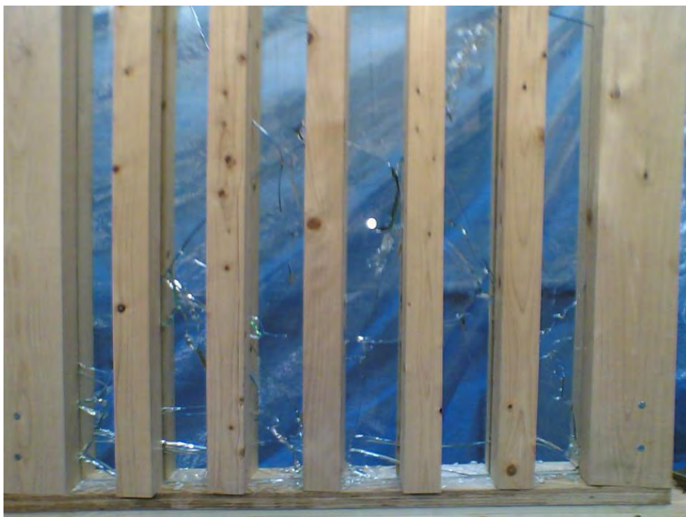
図10 1P ガラス挿入ルーバー耐力壁
