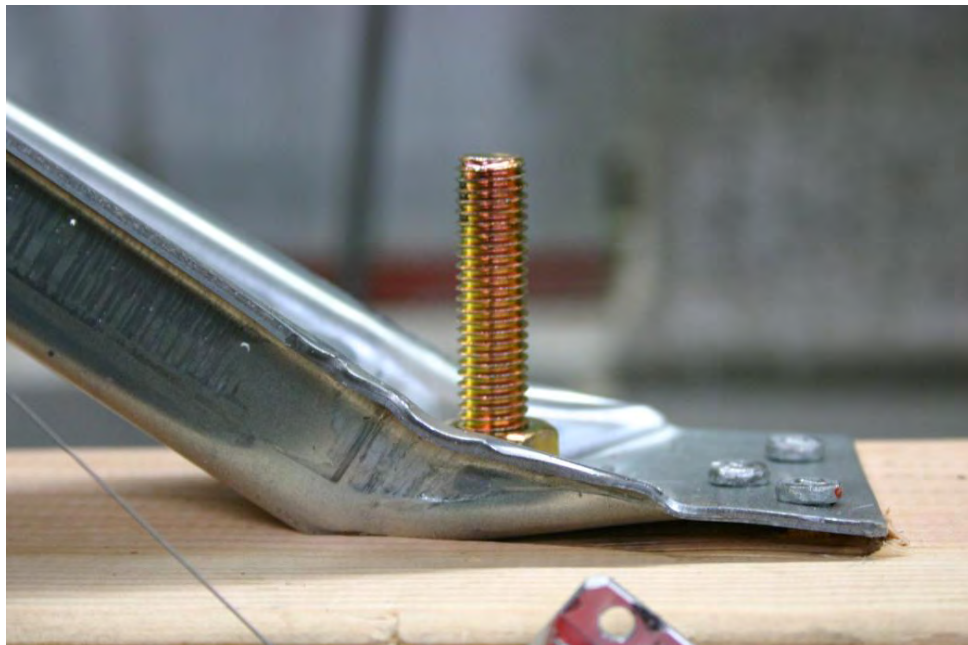
図2 火打ち金物の接合部
