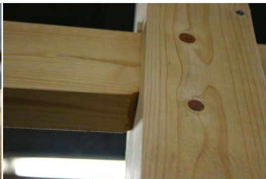
図6 N2-A(HD) 貫接合部のめりこみ
