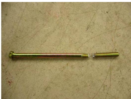
図7 G4-N3-B の試験体破壊形状
