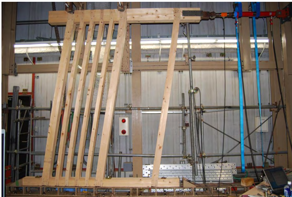
図 22 ガラス有ルーバー試験体の最大変形
