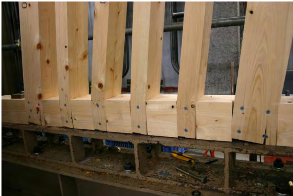
図20 ルーバー試験体の破壊後の様子
