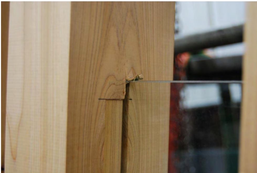
図 24 ガラス有ルーバー試験体の破壊後の様子
