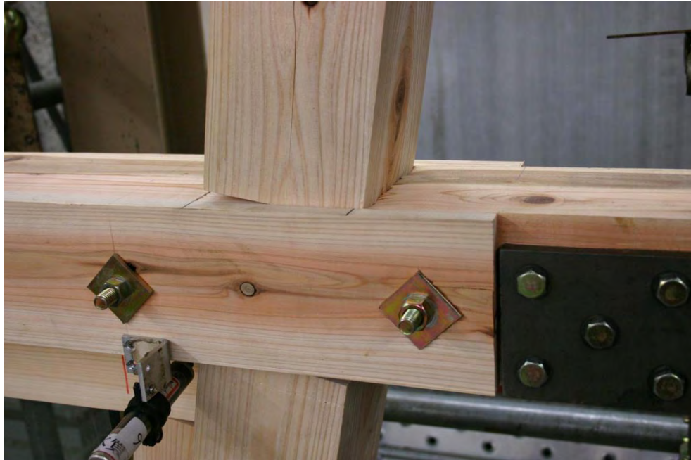
図10 試験体の破壊性状（接合部めり込み）
