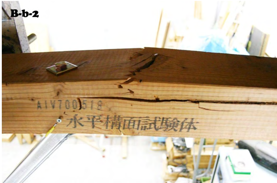
図13 Bタイプ試験体の上部梁材の曲げ破壊
