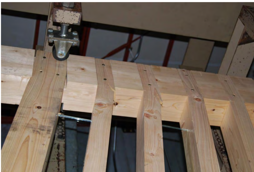
図 23 ガラス有ルーバー試験体の破壊後の様子
