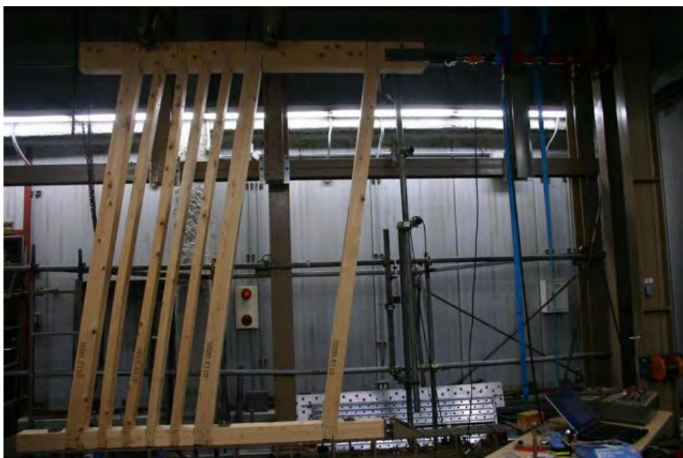
図19 ルーバー試験体の最大変形
