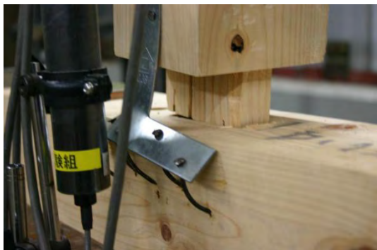
図5 N2-A かど金物の破壊
