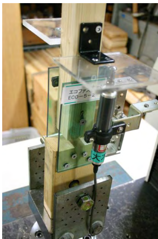
図4 一面せん断試験の様子
