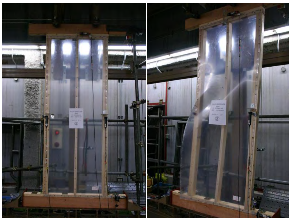
図 24 間柱有+再利用面材
