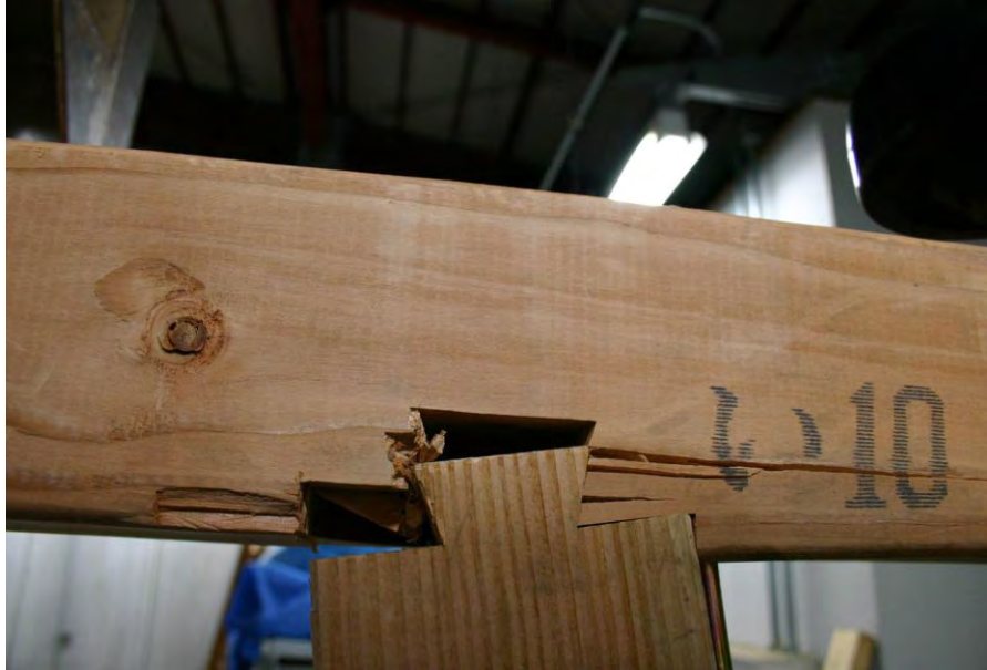
図9 腰掛け接合の破壊図
