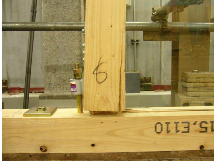
図9 G3-N2-Aの試験体破壊形状
