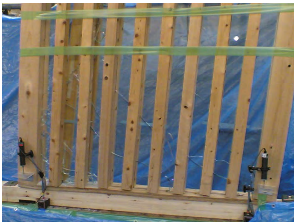
図12 1P ガラス挿入ルーバー耐力壁
