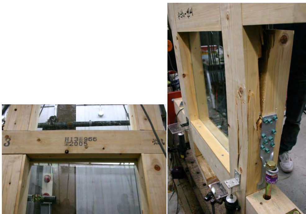
図 12 G5-N4-C の試験体破壊形状
