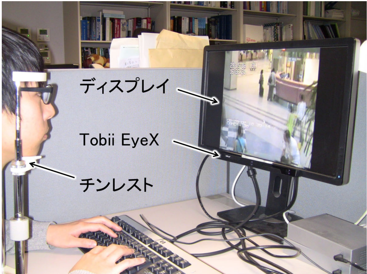
図 4.15 ユーザの注視点データを取得する際の実験環境。ディスプレイは大きさ 23 インチ、解像度 1920×1080 のものを使用した。視線推定には Tobii EyeX を使用した。また、映像を閲覧する際にはユーザの頭部をチンレストを用いて固定し、ユーザとディスプレイ間の距離は 60cm とした。
