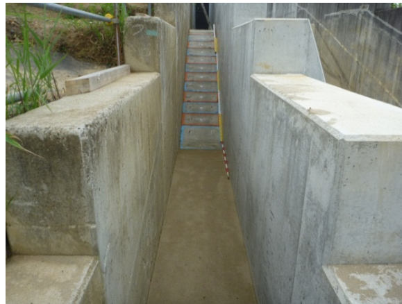
写真-2.6.13 越流前の堤防模型および平坦床
