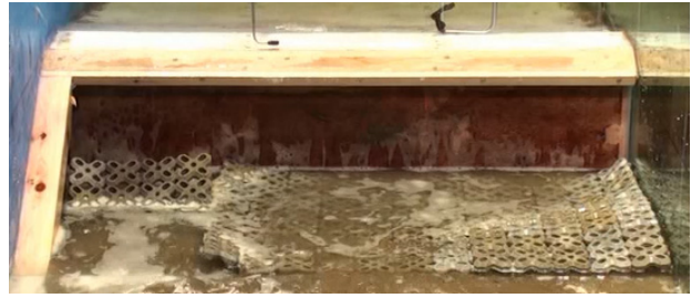
写真-2.6.6 被災状況 (ケース 5)
