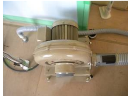
トレーサー送気ファン
