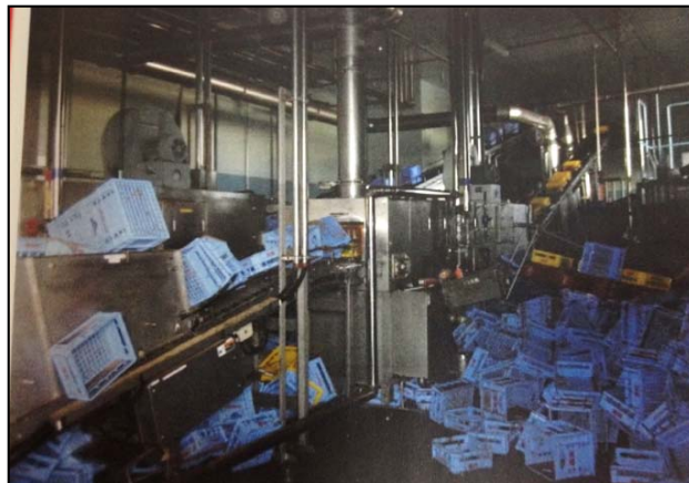
図-87 オーダーメイドの生産用機械が全損（被災者提供写真）
