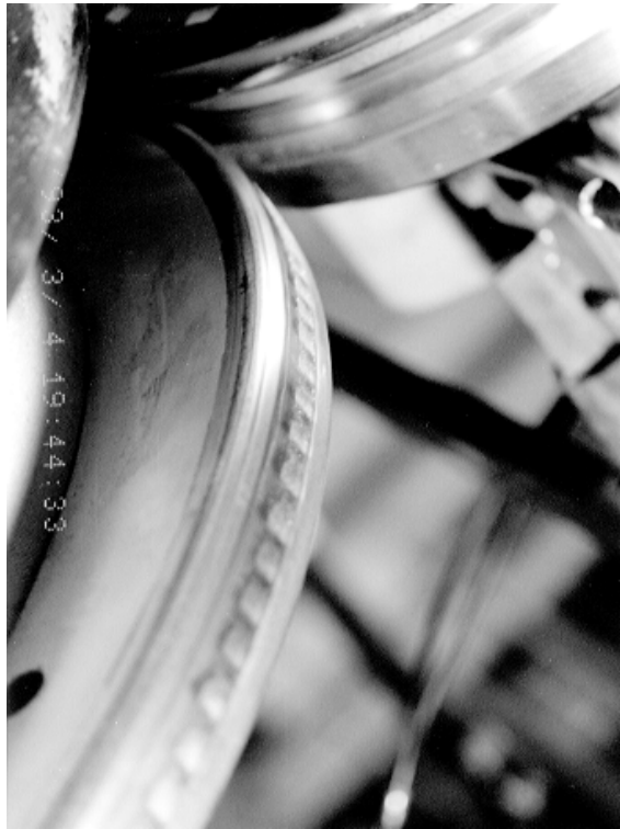
図4-12 試験装置の軌条輪上に発生した波状摩耗 S4-21)
