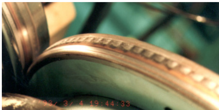
図3-8 軌条輪上に発生した波状摩耗 S4-21)
