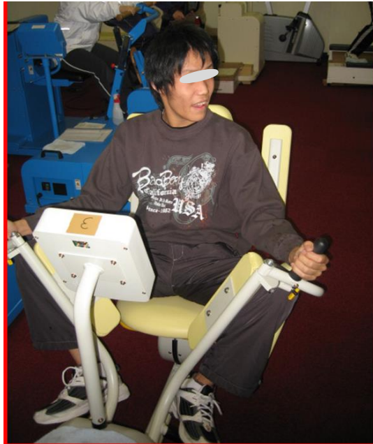
写真 1-3 股関節開閉マシン (コキシアリンク) (股関節の開閉運動を行う。内股を閉める内転筋の運動になる。30 回繰り返す)
