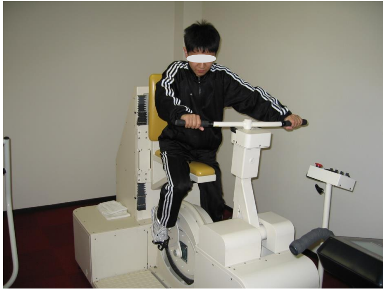
写真 1-9 パワーアシスト付き多動式楕円軌道自転車（略称：リハビリ自転車） （自動的にペダルが電氣的に楕円軌道を描きながら回転する。ペダルの回転に合わせて座席シートの高さが運動中に高くなったり低くなったりする。座席シートの動きに合わせて、ハンドルアームが前に倒れたり、手前側に来たりする。利用者は、自分の意志で、ハンドルのアームを、舵を切るように動かすことができる。5分間行う。）
