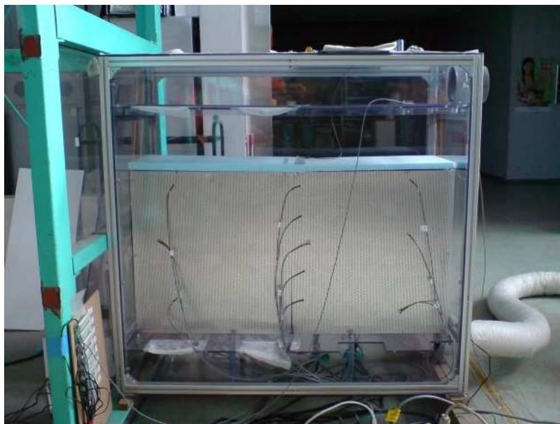
写真4-3 5列設置時（ラック列中央部模擬）
