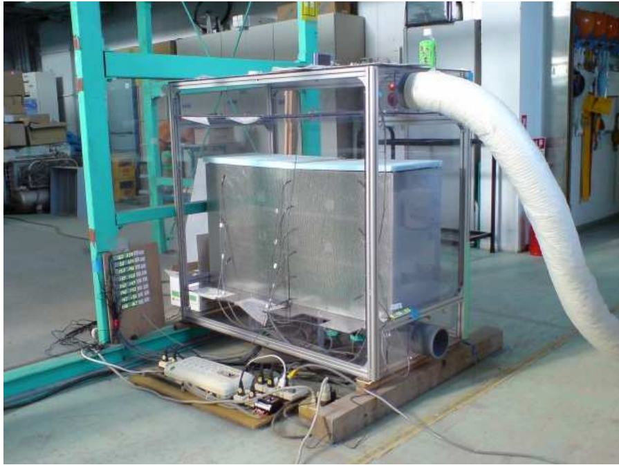
写真 4 - 1 縮小模型外観（天井吹出し方式・ラック列中央）
