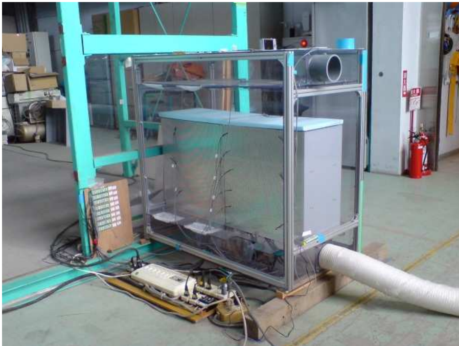
写真 4 - 2 縮小模型外観（床吹出し方式・ラック列中央）
