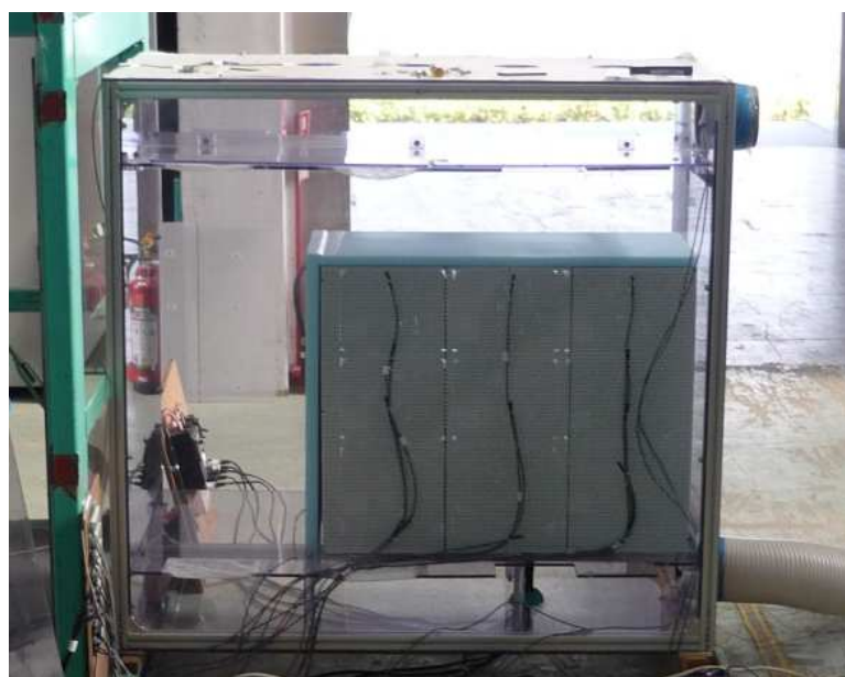
写真4-4 3列設置時（ラック列端部模擬）
