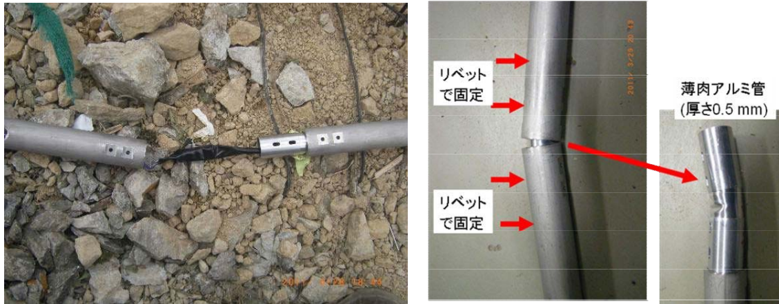
図 4 - 5 小型孔内傾斜計のロッドの接続
