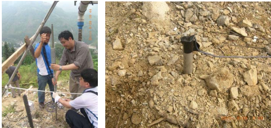
写真 4 - 2 小型孔内傾斜計の設置の様子
