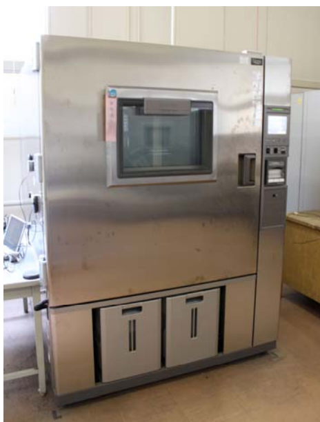
写真3-7 冷熱衝撃試験の実施状況
