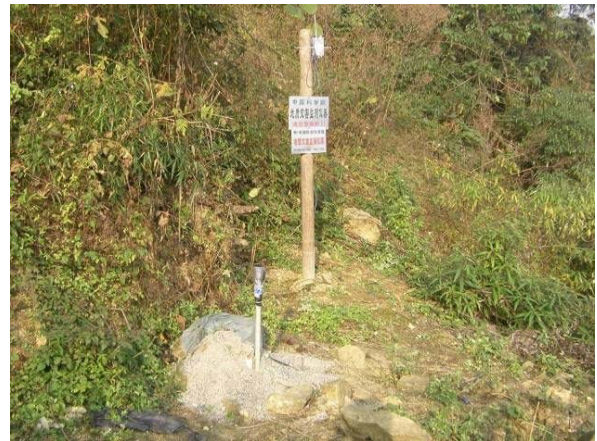
写真4 - 6 小型孔内傾斜計の設置状況
