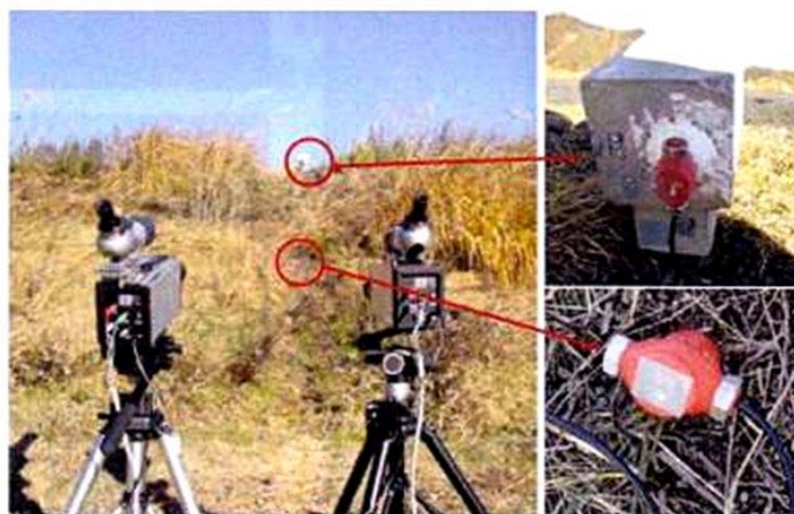
(b) ターゲットと地震計の設置状況
