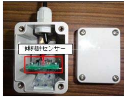
(b)MEMS 傾斜検知モジュール ( 地中埋設型 )
