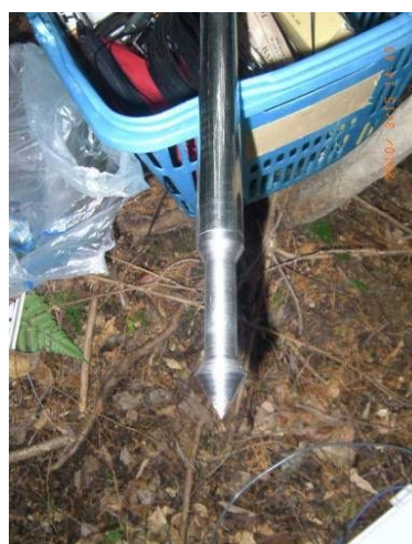
( b ) 载荷端ロッドの先端部
