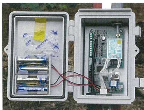
斜面崩壊検知センサー
