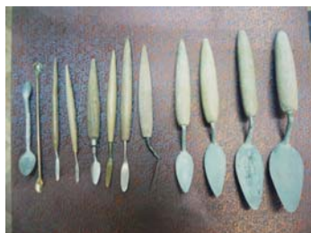
【図 1-55】台湾土糊兼剪粘職人の使用する鏝（筆者撮影）
