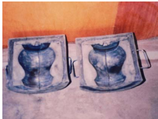
【図 1-106】型製造の人造石洗出しの型（筆者撮影）
