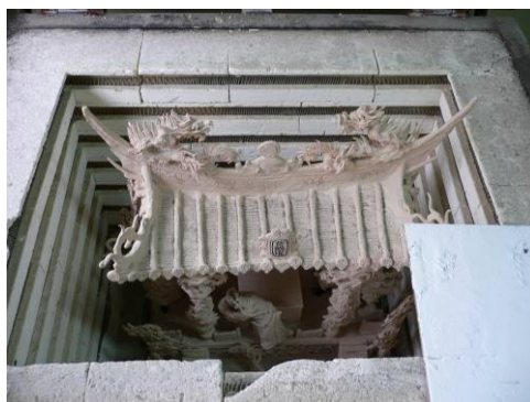
【図 2-84】窯の容量に限りがあること。作品のサイズが大きすぎる場合には幾つかに分割して窯に入れる(筆者撮影)
