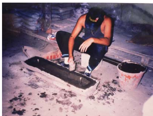
【図 2-36】型とモルタルの間の剥離剤に鉛パウダーを塗りつける作業（郭互富提供）
