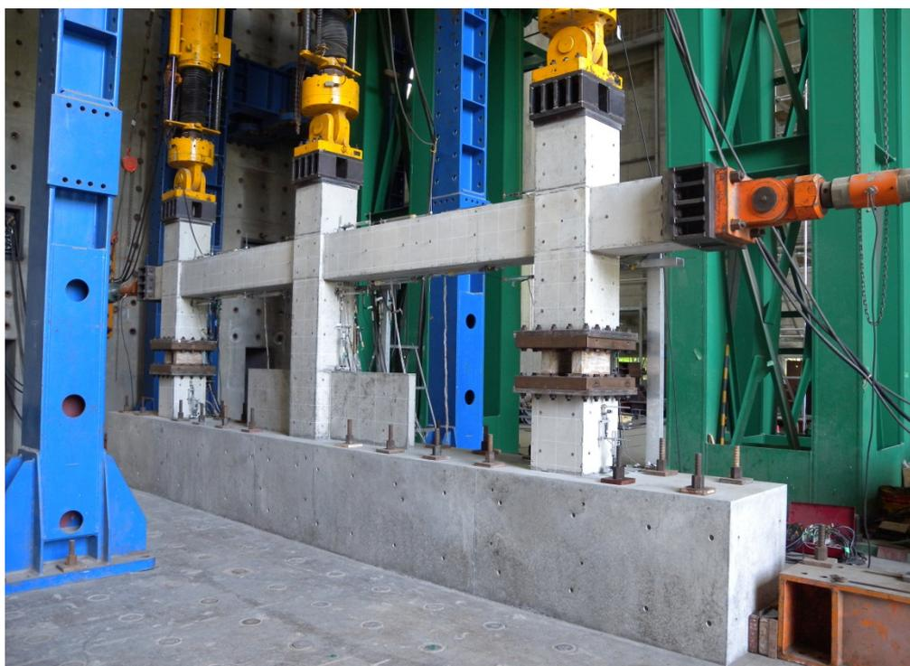
写真 3.1 1SH-64 試験体の加力システムの全景
