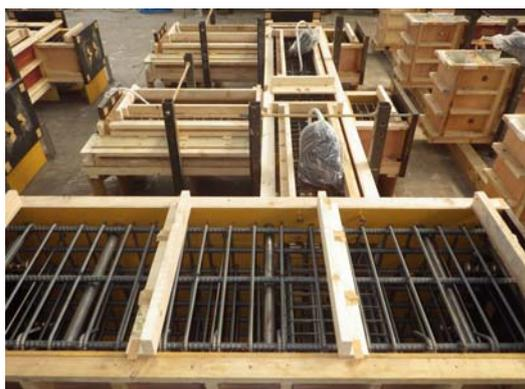
(a) 配筋様子 (2SH-07-07-W 試験体)
