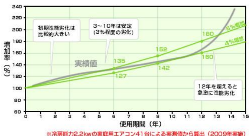
図 5-3 エアコンの劣化と消費電力の推移（データ出所：エネデュース）
